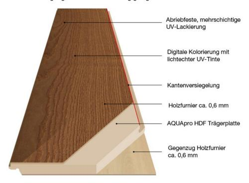
Abbildung 1 Querschnitt
