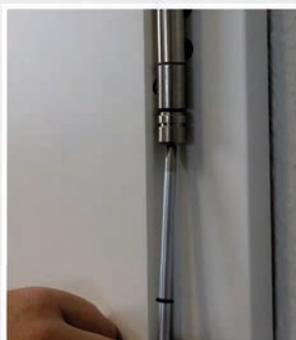
**7** Die Position des Türblattes kann durch eindrehen, bzw. herausdrehen der Bänder geändert werden. Hierzu die Tür aushängen, 1-2 Umdrehungen das Band drehen und die Tür wieder einhängen.
