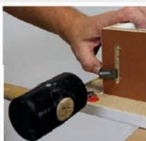
**4** Stahlklammern in vorgesehene Nute stecken und mit dem Hammer in die entsprechende Gennut einschlagen. Je aufrechtem Zargenteil 3 Klammern einsetzen. Ggf. austretenden, überschüssigen Leim umgehend von der Oberfläche entfernen. Leim ca. 15 min. abbinden lassen.
